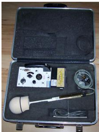
Εικόνα 4. Παράδειγμα μετρητή ηλεκτρομαγνητικού πεδίου της εταιρείας Narda
