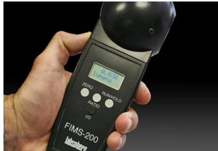
Εικόνα 1. Παράδειγμα απλού φωτόμετρου της εταιρείας Pro-Lite Technology
