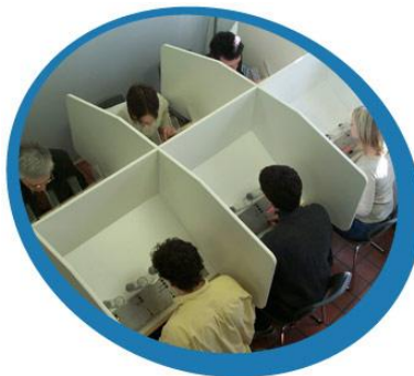
Εικόνα 3. Παράδειγμα ολφακτομετρικής διάταξης από την εταιρεία Odotech.
